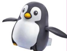
太陽電池で発電した電気エネルギーをミニ充電機にためて動くペンギン型ロボットです。
